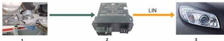
1. Sensore di livello 2. Modulo dei fari 3. Attuatore del faro HID
