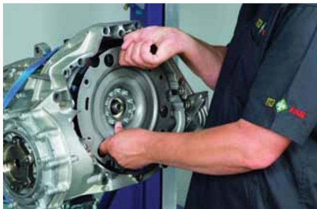
**Dopo avere montato l'attrezzo speciale (impugnatura) sul disco di azionamento, inserite l'unità frizione nel cambio.**
