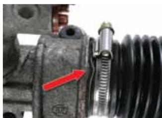
Gli esperti di ZF Services raccomandano di usare fascette per cavi o per tubi universali, non conformi con gli standard OE, per fissare le cuffie di sterzo. Sono assolutamente inadeguati per la tenuta a lungo termine e possono causare bypass. In tal caso, la penetrazione
